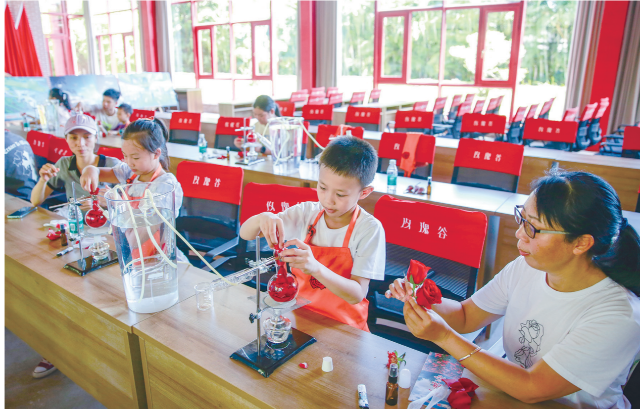
在亚龙湾国际玫瑰谷,孩子们使用水蒸气蒸馏法提取玫瑰纯露。
