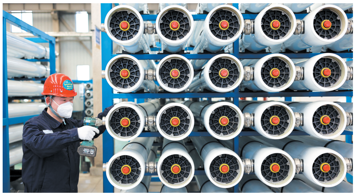
3月14日，工人在山东省滨州市惠民县辛店镇一家水处理设备生产企业车间内生产纯水反渗透膜壳。
