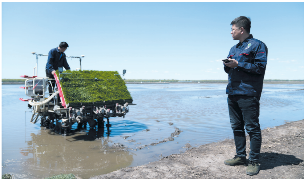
陆向连(右)用手机操控带有北斗导航系统的插秧机(5月18日摄)。新华社记者 王建成 摄
