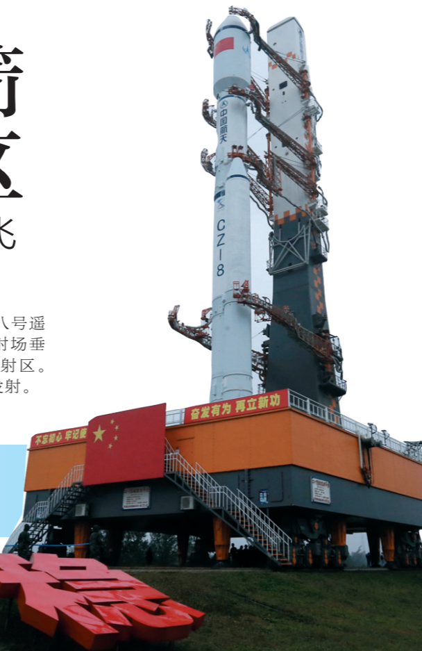
右图:12月16日8时20分,承载着长征八号遥一运载火箭的活动发射平台,驶出发射场垂直测试厂房,平稳行驶、安全转运至发射区。后续,火箭将加注推进剂,按计划实施发射。新华社发(国家航天局供图)
