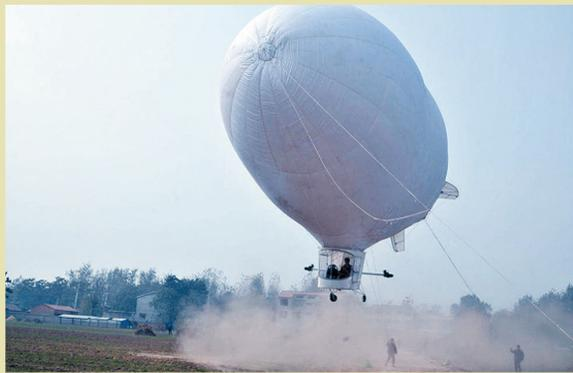
2015年10月25日,河南商丘,宁陵县男子时松波自费30万元研制一架载人飞艇,在田间道路上试飞取得成功。飞艇高10米、长23米,可乘坐2人,飞行高度500米,时速达50公里。
